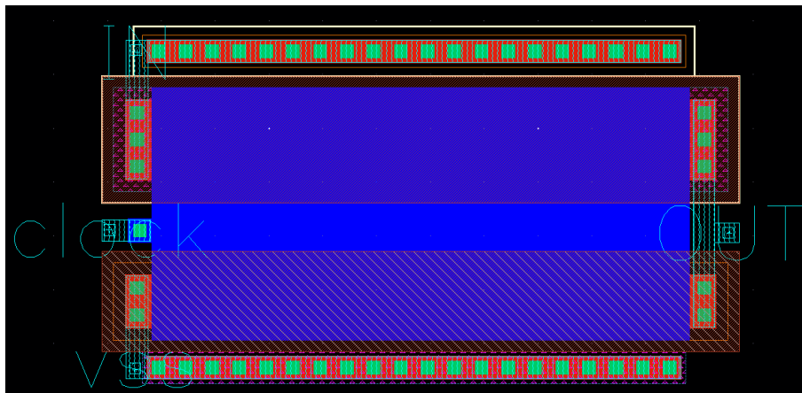
Figura 5.10: Vista de layout del interruptor
